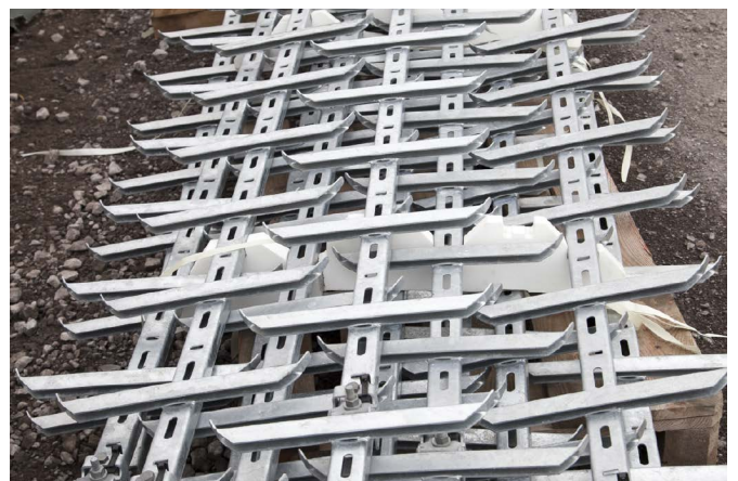
WEA 6 Aufstiegsэлеmente für den Einbau in den Turm
